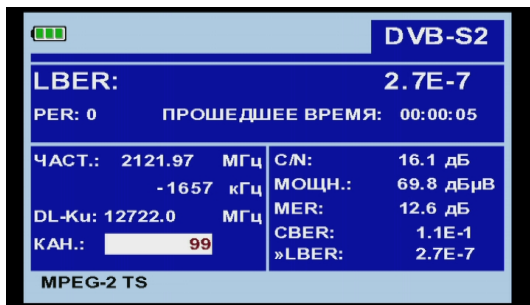
Рис. 42.- Экран измерения LBER сигналов, модулированных в QPSK/8PSK. (DVB-S2).
