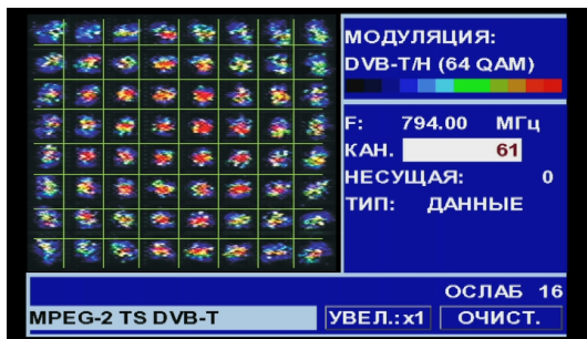
Рис. 45.- Конstellяционная Диаграмма. Сигнал DVB-T/H (QAM 64).
